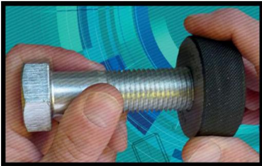
**Contrôle de filetage et Taraudage**
